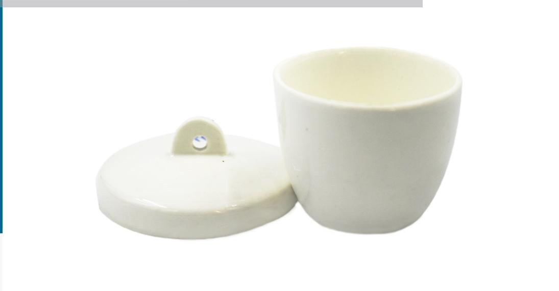
Los crisoles de forma alta incluyen tapas. Los crisoles están vidriados en las superficies interior y exterior excepto en el borde y el fondo exterior. Esterilizable en autoclave. Resiste temperaturas de hasta 1150°C. Para evitar grietas por estrés térmico, recomendamos encarecidamente una tasa de calentamiento/enfriamiento que no supere los 200 °C por hora. Los crisoles de porcelana unidos ofrecen una excelente resistencia a los ácidos y álcalis excepto al ácido fluorhídrico.
